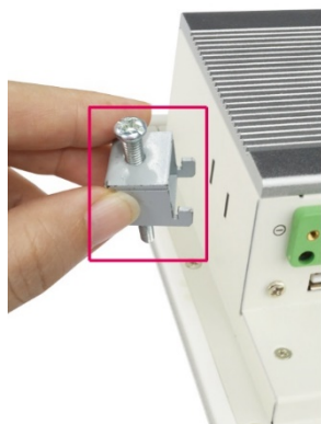
Крепление панельного компьютера устанавливается как показано на фотографии
